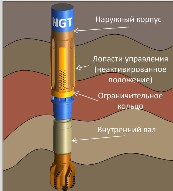
ИБВС состоит из невращающегося **наружного корпуса** и вращающегося **внутреннего вала**, который присоединён к долоту и бурильной колонне. Наружный корпус включает корпус управления, **лопасты управления** и механизм управления.
