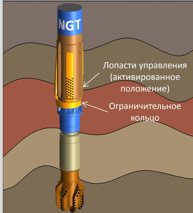
Как только ствол скважины начинает отклоняться от вертикали, «Система Автоматического Управления» инструмента мгновенно реагирует и выдвиганием одной или двух лопастей управления создает корректирующее боковое усилие и направляет траекторию скважины обратно к строгой вертикали.
