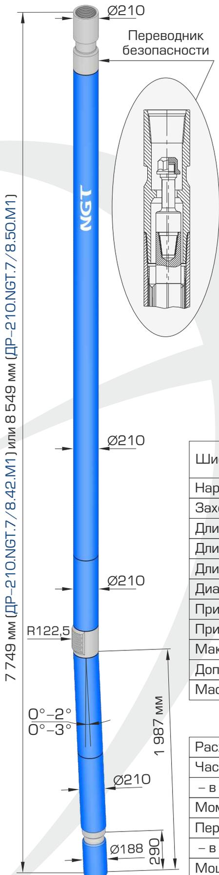
ВЗД ДР-210.NGT.7/8.42.M1 и ДР-210.NGT.7/8.50.M1 представляют собой новые универсальные гидравлические забойные двигатели для бурения нефтяных и газовых скважин шарошечными долотами, долотами PDC диаметром 250,8–374,6 мм.
