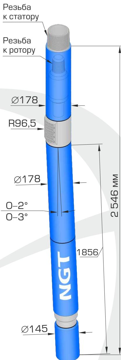
Шпиндель **S-178.NGT.M12** – это новый короткий шпиндель с повышенным ресурсом работы. Шпиндель предназначен для работы с рабочими парами винтовых забойных двигателей диаметром 172–178 мм, и применяется для бурения нефтяных и газовых скважин долотами 212,7–250,8 мм.
