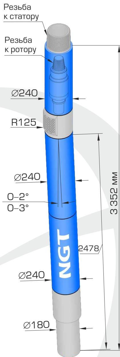
Шпиндель S-240.NGT.M1 – это новый короткий шпиндель с повышенным ресурсом работы. Шпиндель предназначен для работы с рабочими парами винтовых забойных двигателей диаметром 240 мм, и применяется для бурения нефтяных и газовых скважин шарошечными долотами, долотами PDC диаметром 295,3–444,5 мм.
